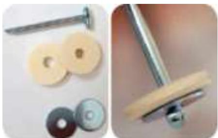
Поместите металлический диск на шплинт, затем установите деревянный диск. Установите шплинт с дисками в головку и закрепите его. Сам шплинт должен быть снаружи, как вы можете видеть на фото ниже.
